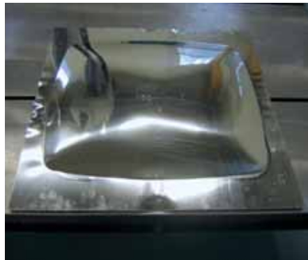
Kuva 4: JaloteräsStudion impulssimuovaimella tehty säiliön päätyaihio.
